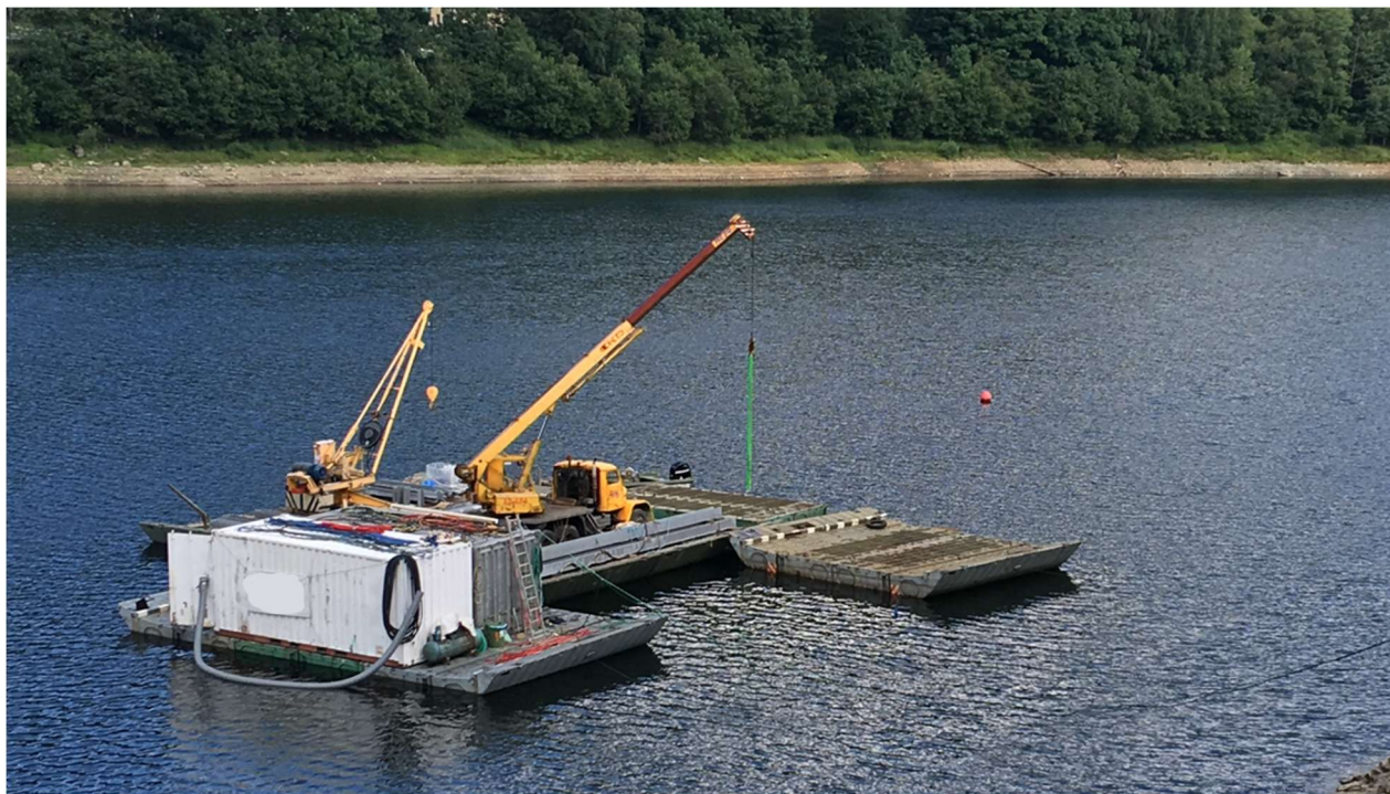
Fotografie pracovního pontonu se jeřábovým zařízením
